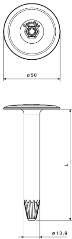
Fig. 5 ASTL50 fastebrikke / hylse Hylse lik RP50n, tilpasset for bruk med skruer ACS-6,1
