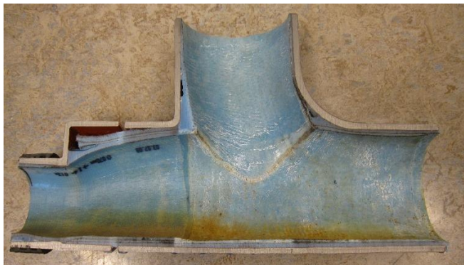
Fig. 2 Lengdesnitt av rør med relining med fiberstrømpe og epoksy
